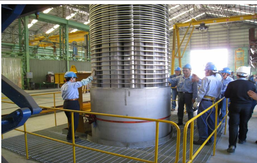
密封鋼筒組件組裝情形
