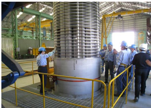
用過核子燃料密封鋼筒組件組裝情形
