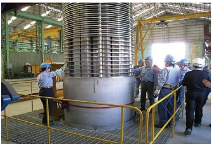
用過核子燃料密封鋼筒組件組裝情形
