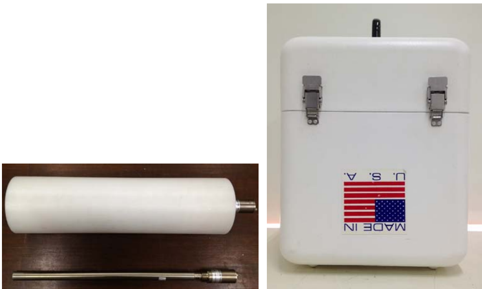
圖十、高效率 He-3 中子偵檢器(左)及 HPIC 加馬劑量率偵測儀器(右)
