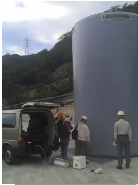
圖十一、護箱表面背景輻射量測作業之量測實況
