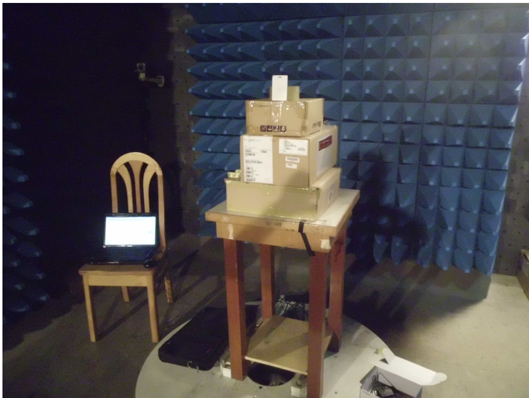
圖 4：在電波暗室中進行射頻識別裝置的量測實驗
