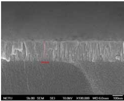
圖十二、(a) 直流功率 100W 之 ZnS 薄膜 SEM 圖
