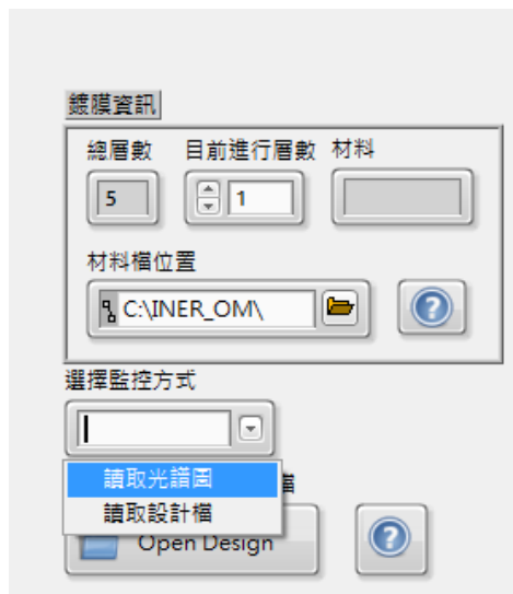
圖 3-3 選擇監控方式有讀取預計停鍍穿透光譜和依照設計檔計算預計停鍍光譜兩種監控方式
