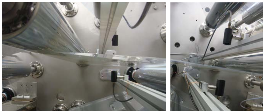
圖 2-1 R2R 之穿透光量測系統設備架構
