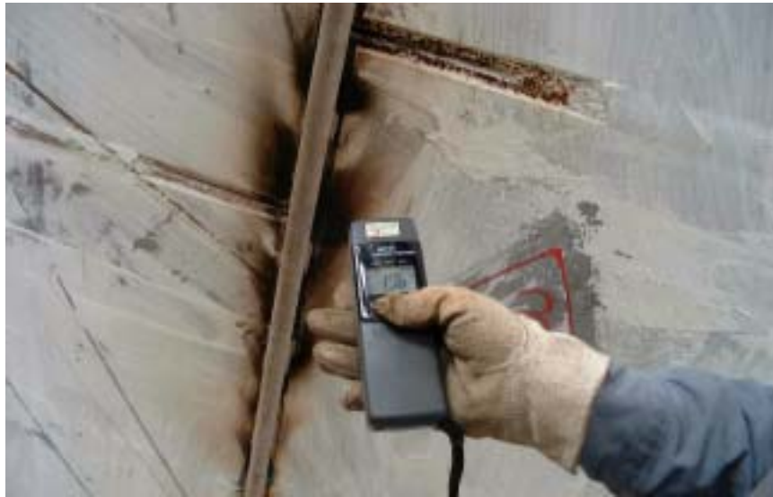
照片七：鐸道預熱溫度量測
