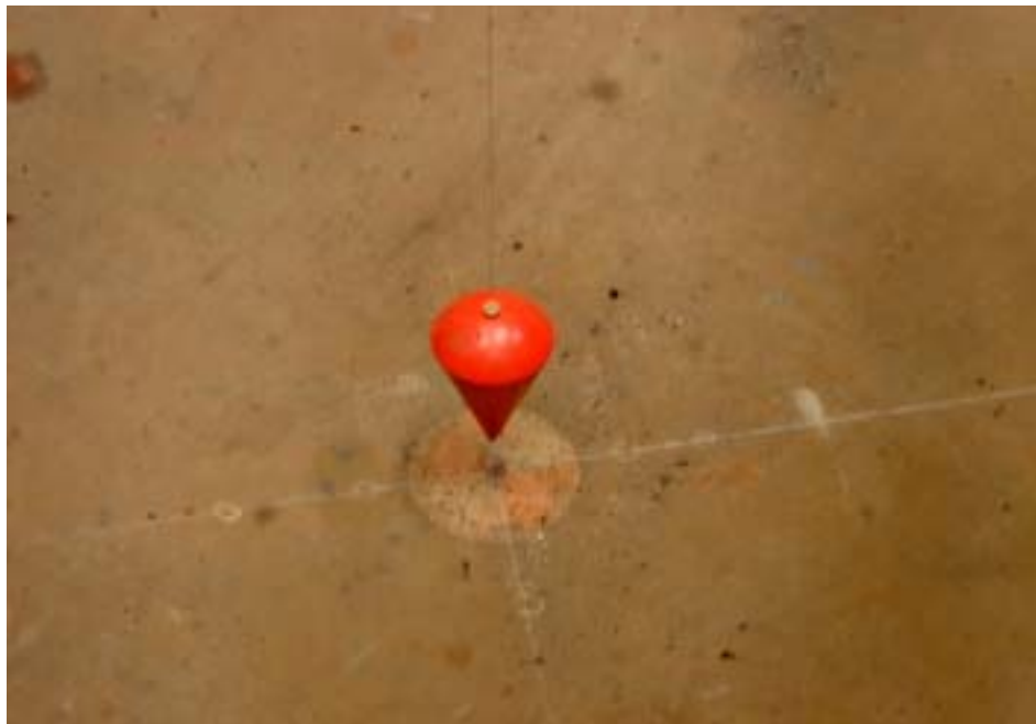
照片二：鉛垂線建立量測基準
