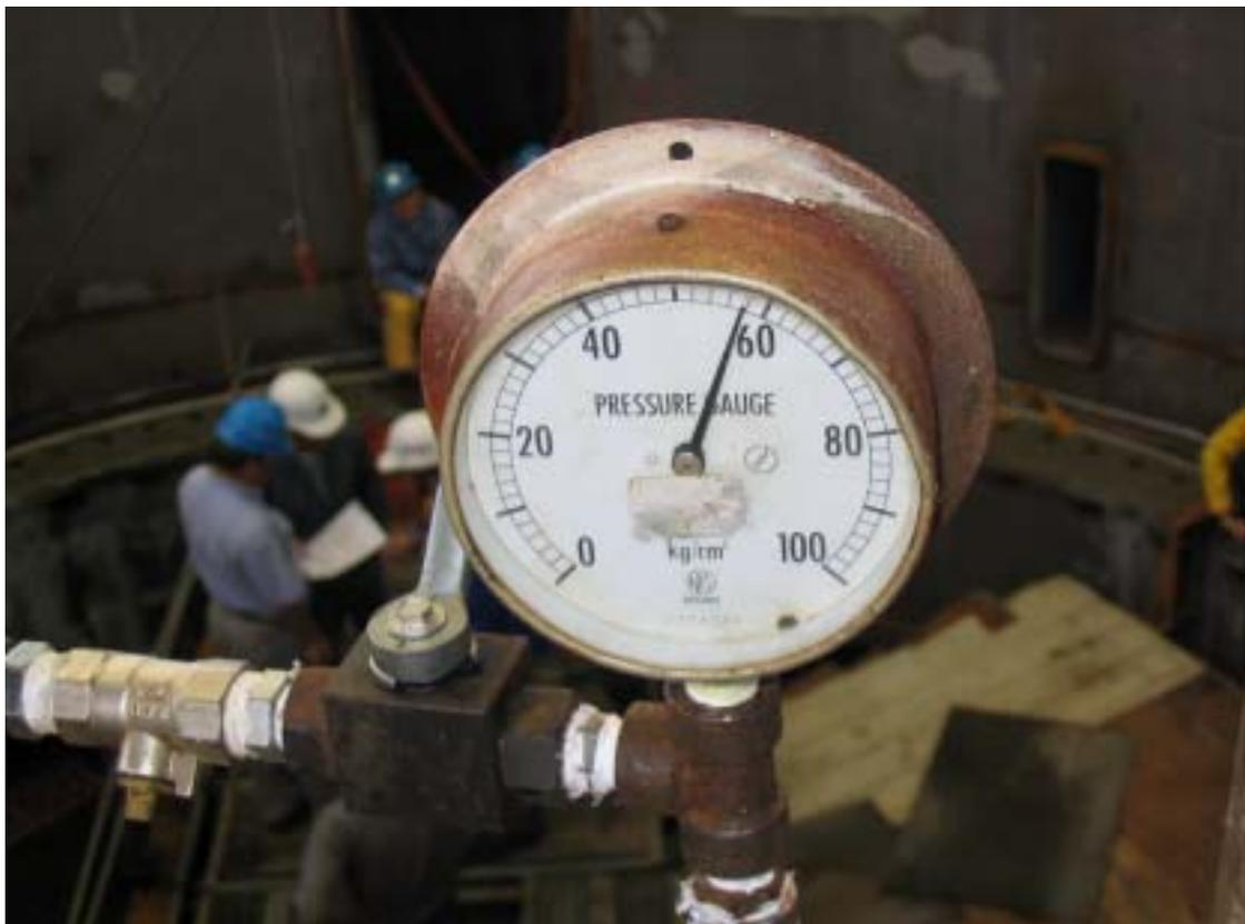
圖二：SRV VENT PIPE 水壓測試情形
