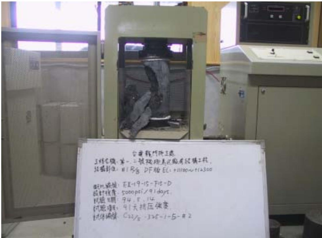
圖十四：抗压試體試驗情形
