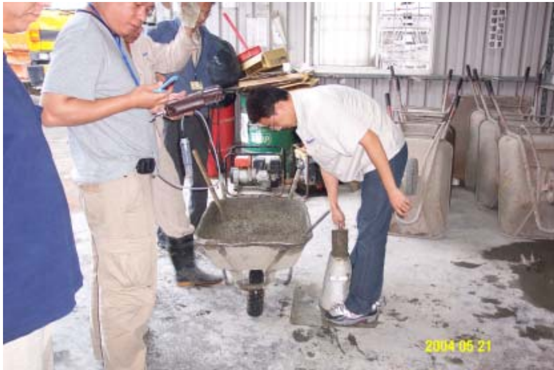
圖五：混凝土澆置出廠前取樣試驗情形
