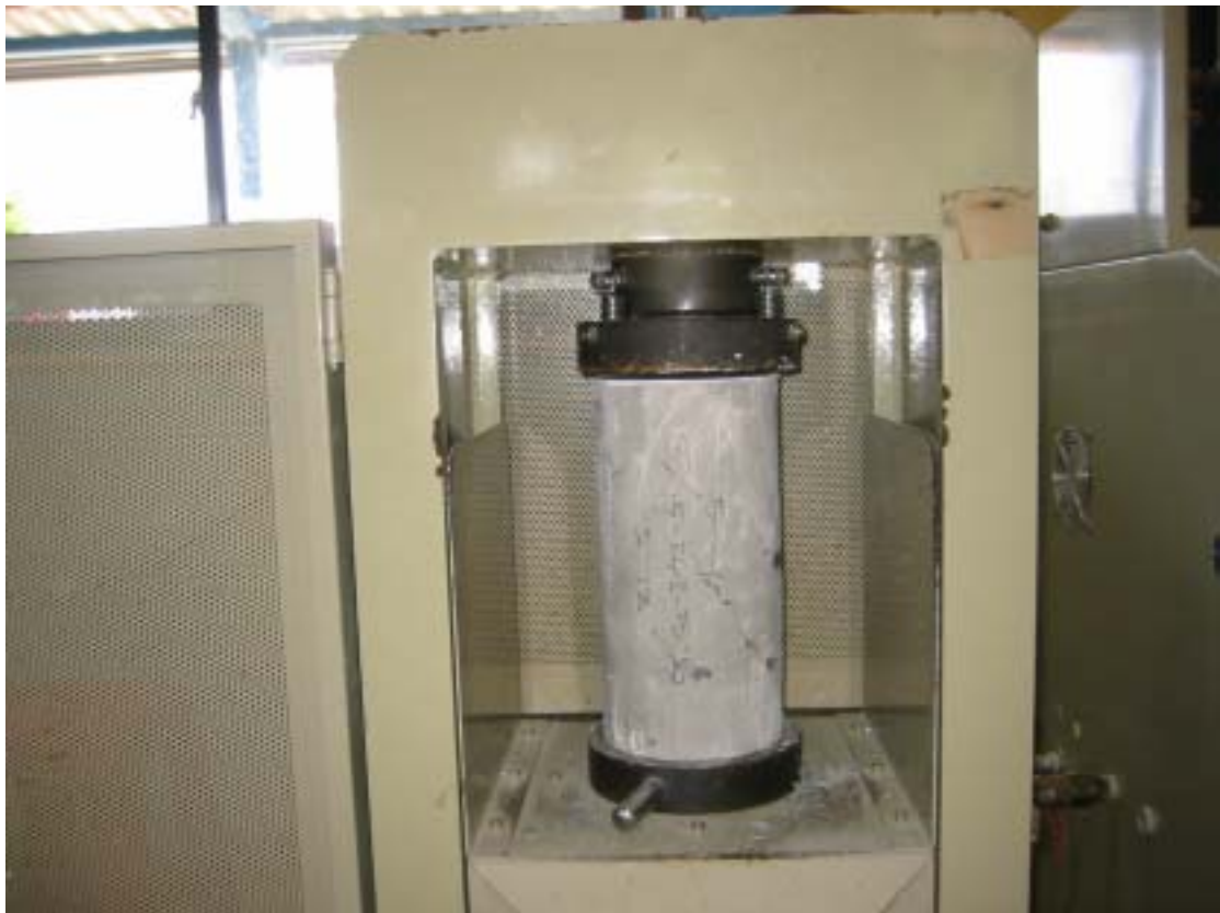
圖十六：混凝土圓柱體抗壓試驗作業情形
