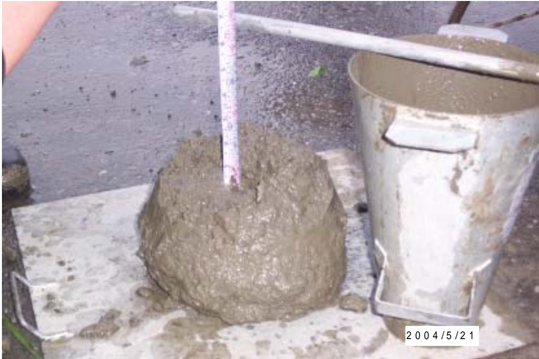
圖七：混凝土取樣進行坍度試驗情形
