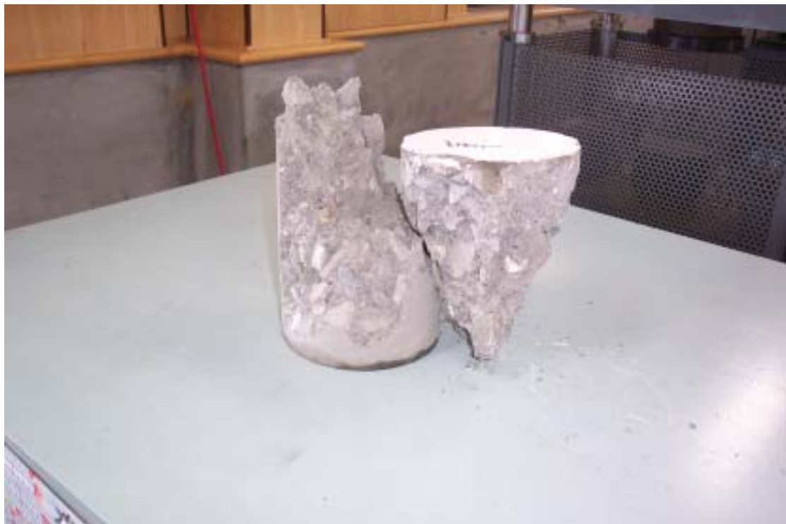
圖二十：混凝土試體破壞後情形
