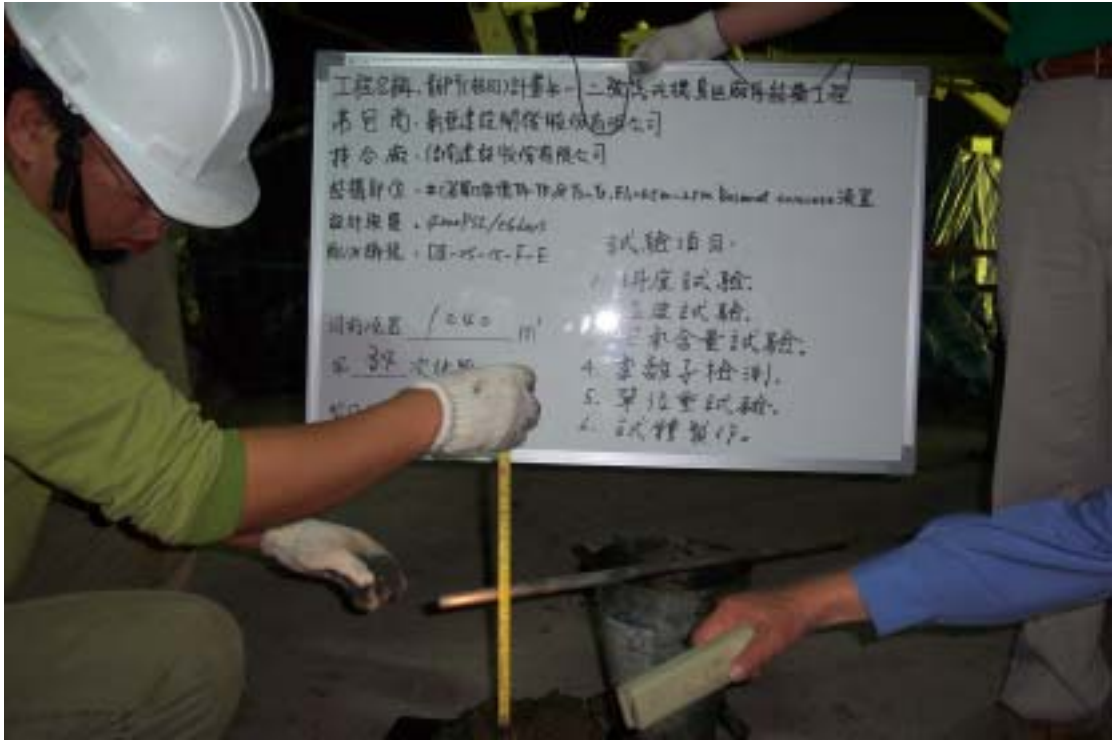
圖五：混凝土坍度試驗現況（4/1 01：10）
