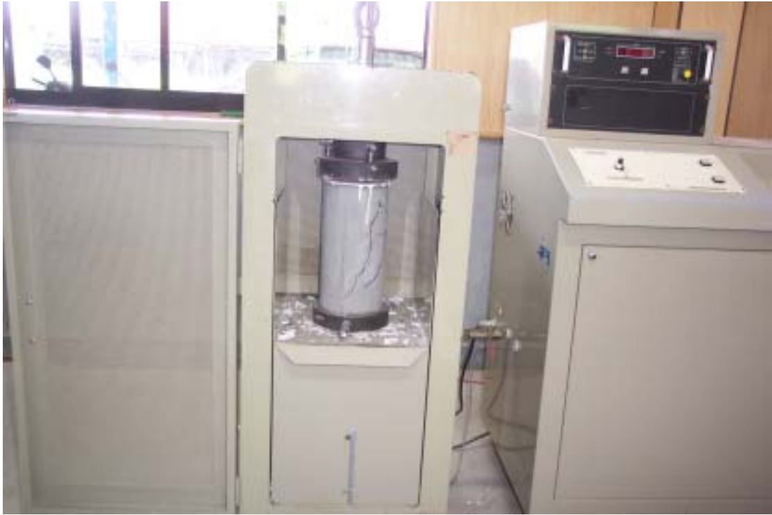
圖十九：混凝土抗壓試體試驗後裂縫生長情形
