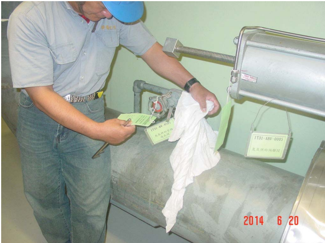
照片 2：測試人員以清潔白布蓋確認加壓空氣無油、水沉積
