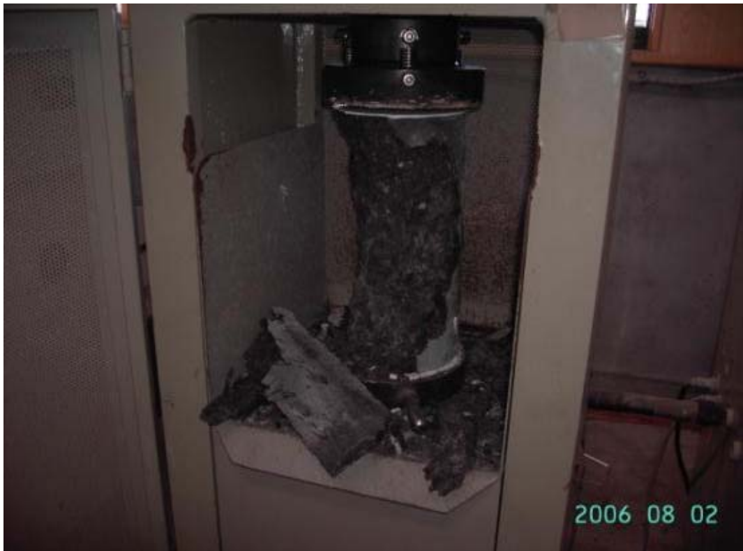
圖 12：混凝土試體抗壓試驗作業情形
