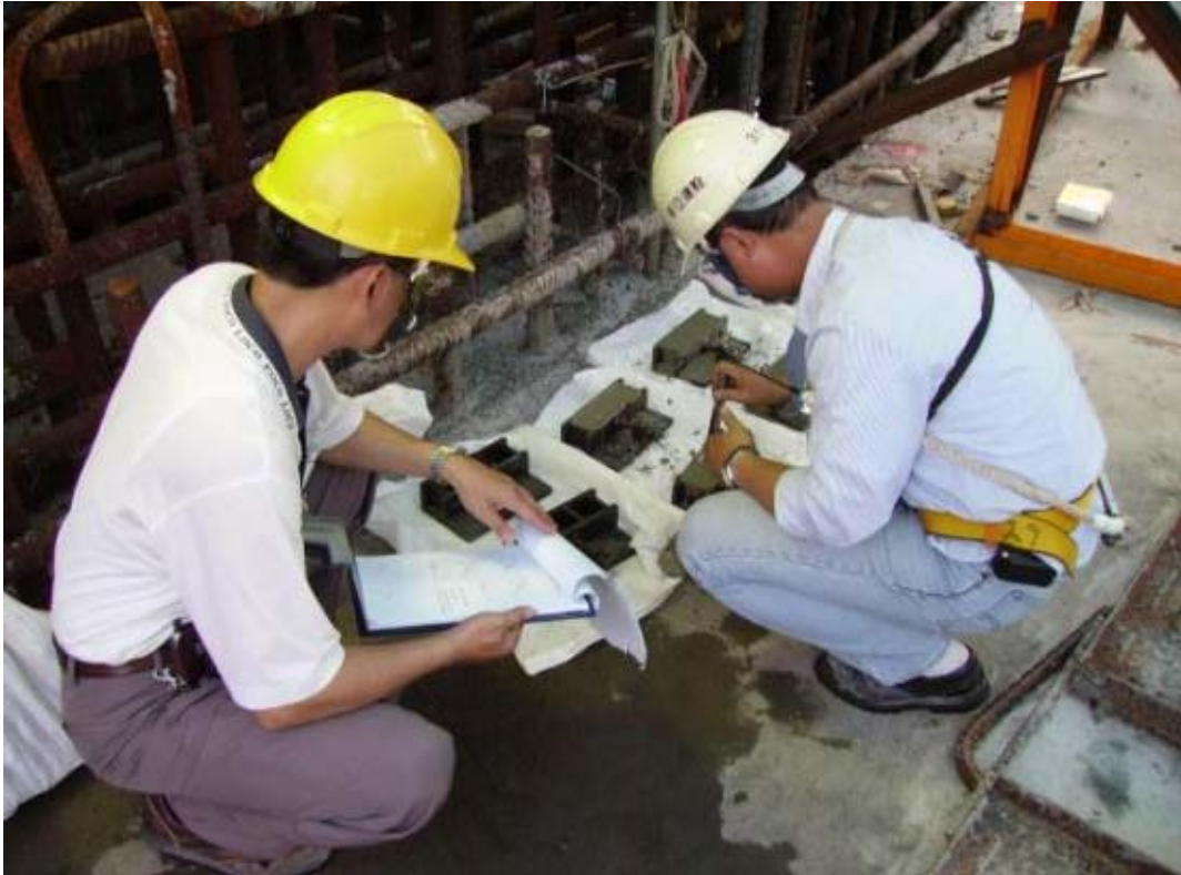
圖 7：二號機基座之 RPV 支撐座二次澆置不收縮水泥漿取樣情形
