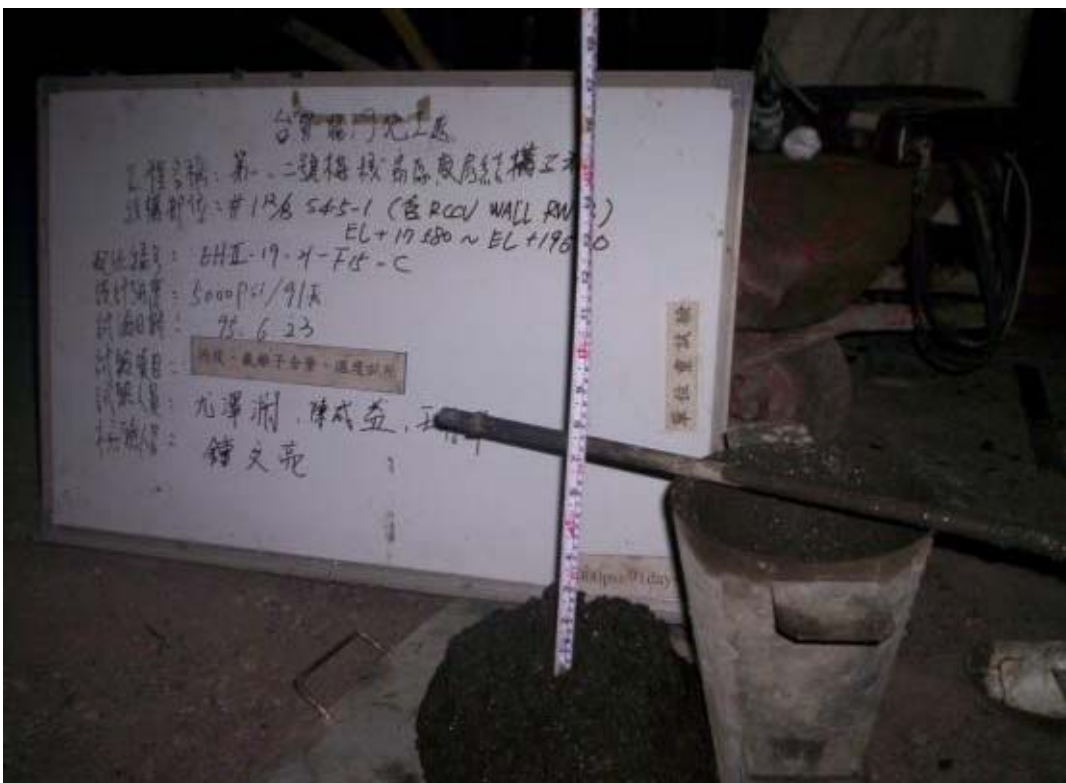
圖 10：混凝土取樣試驗作業情形
