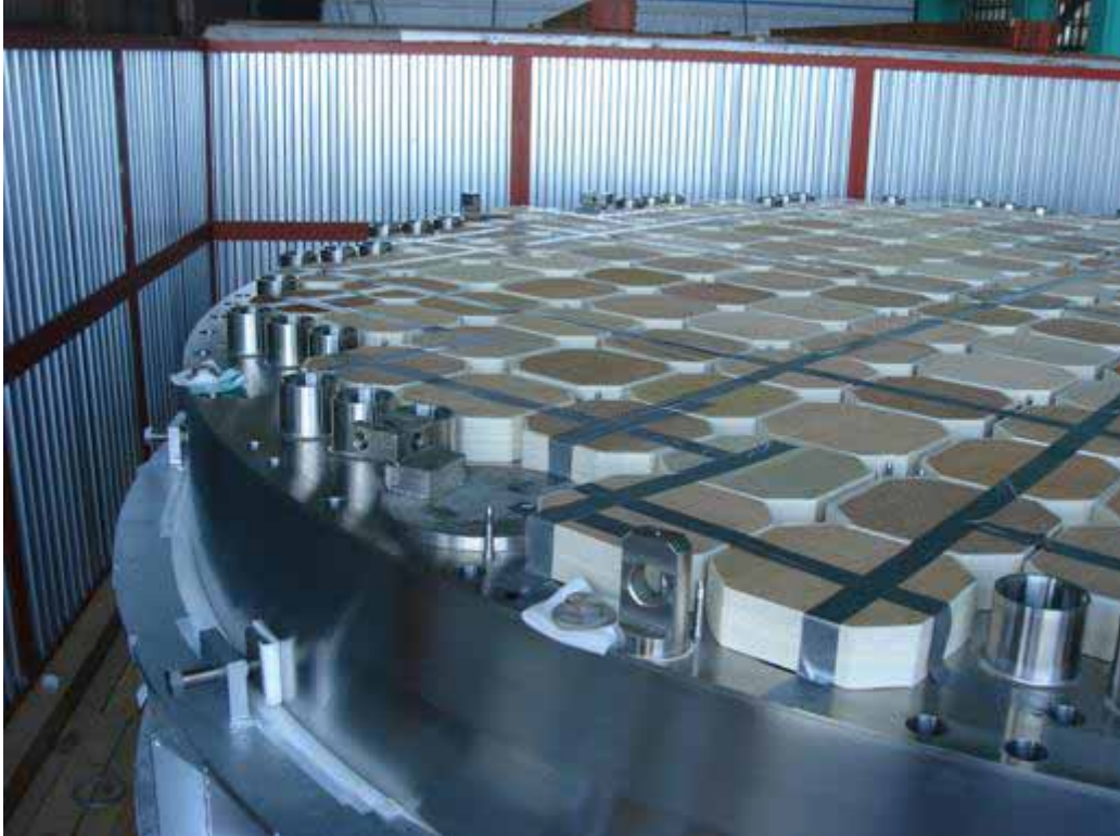
圖-9、爐心底板在倉庫待運之場景。圖中棕色方塊為每個 CRGT 孔的保護罩，共有 205 個；短圓柱為 peripheral fuel support，共有 52 個；邊緣共有 81 個螺栓孔，另有 20 個定位銷孔無法從此角度看到；圖內右下角離開邊緣的孔研判應為 CP \Delta P 孔。CRGT 孔保護罩之間可以看到 CRGT 的方向銷、ICGT 孔即位於其間；4 個 CRGT 局部的仰視圖如下。CRGT 保護罩之高度高於方向銷，以免施工過程之不必要碰撞。
