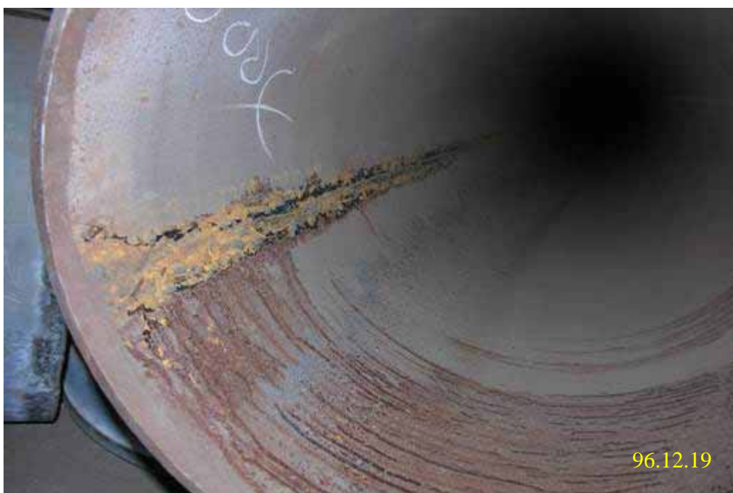
照片九：一號機汽機廠房管路系統安裝前管節內部表面鏽蝕情形
