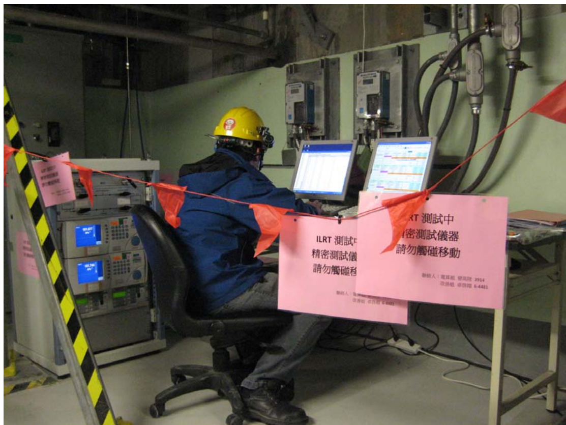
照片 4：SIT 測試作業現場加壓控制站(加壓前)
