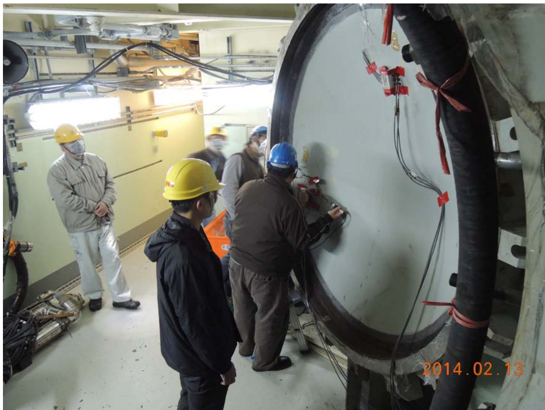
照片 2：SIT 測試前先備測試儀器之現場視察（金屬設備應變計安裝）
