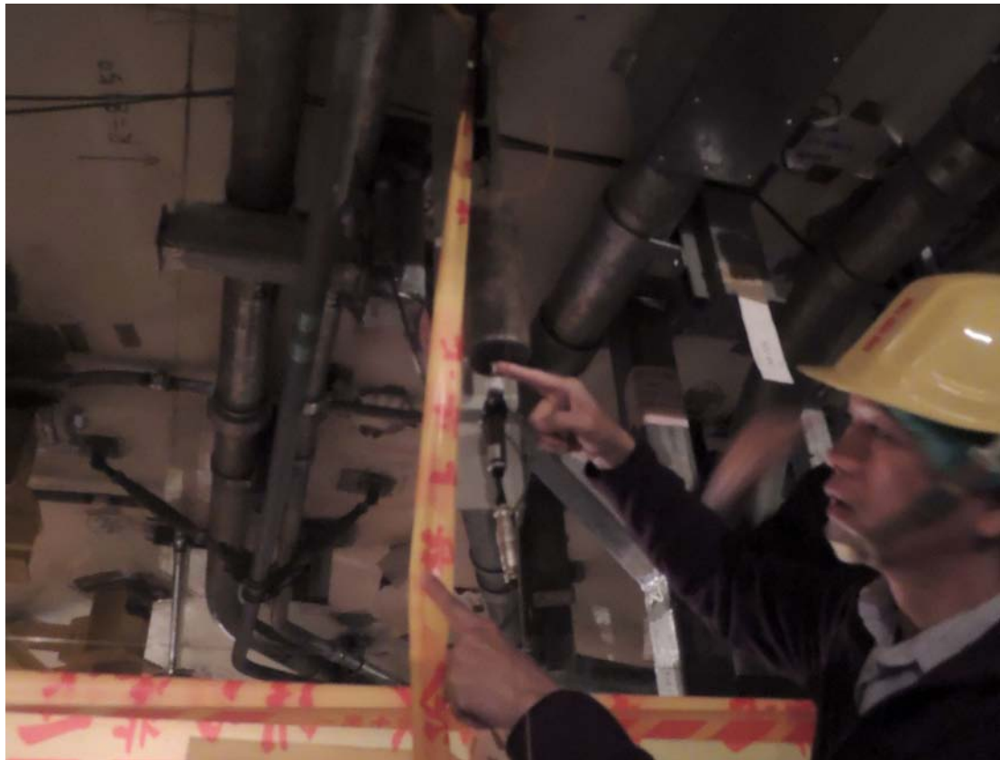
照片 3：測試前先備測試儀器設施之現場視察（鋼鋼線及變位計）
