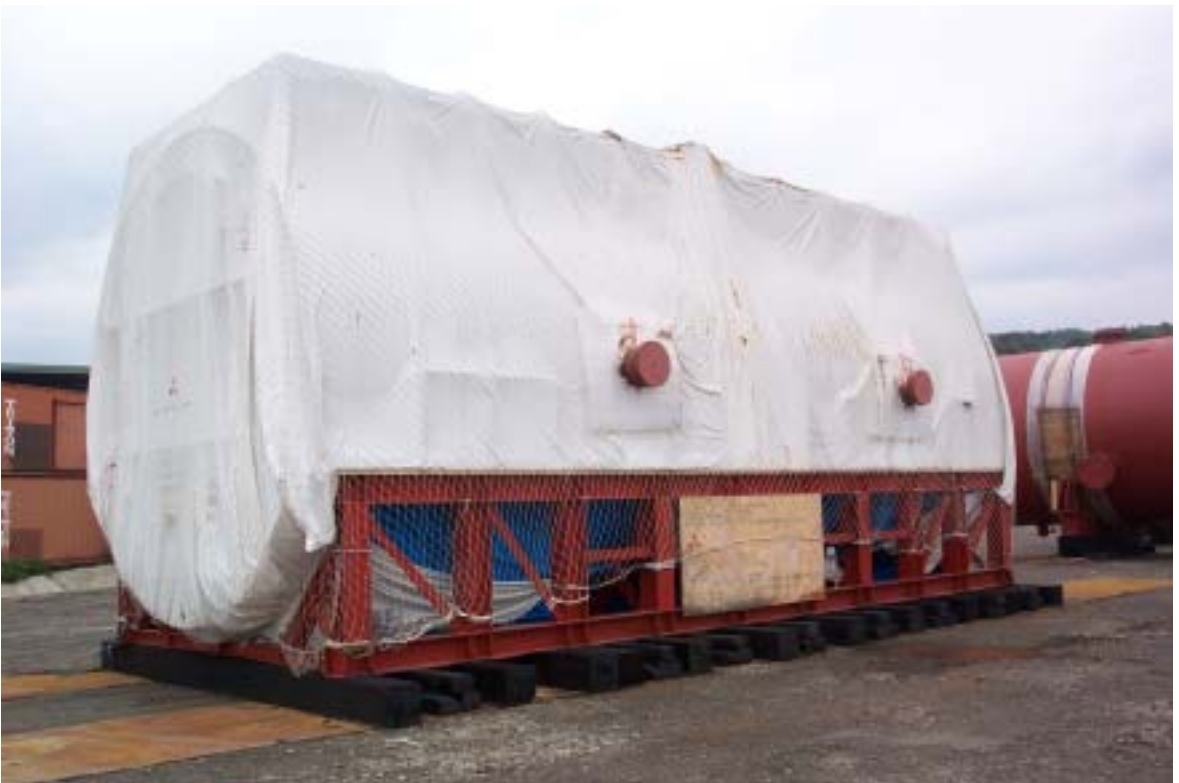
圖六：Generator Stator 為 B 級儲存等級，儲存於 D 級重件儲存場現況
