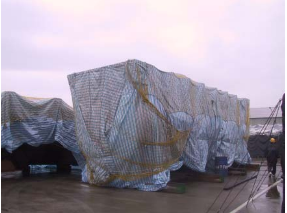
圖五：Main Oil Tank 為 C 級儲存等級之儲存現況
