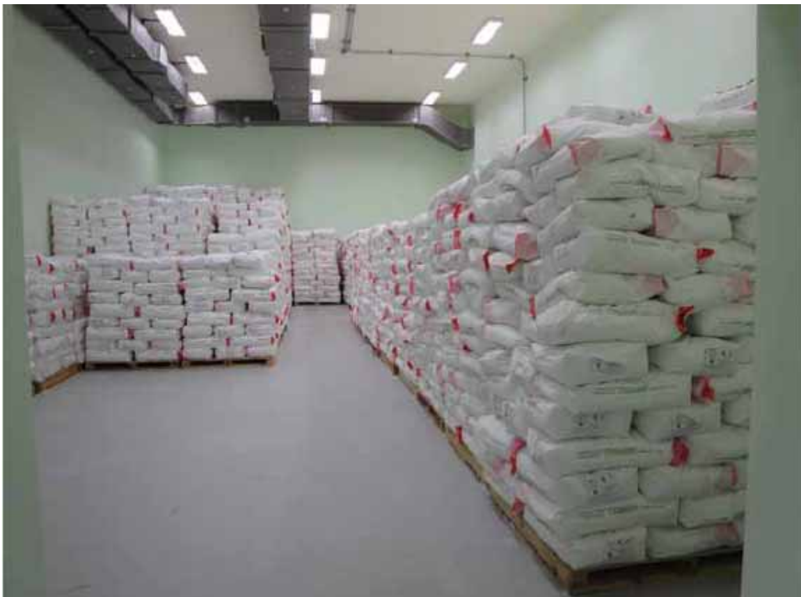
圖六 已購置放於低階廢料倉庫避免燃料重新臨界用之硼酸
