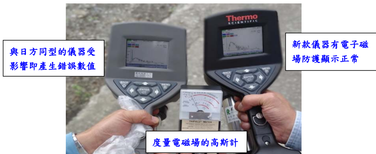
圖五：BNC SAM-940(左)與新公司製造同款的儀器(右)比較，BNC 易受
