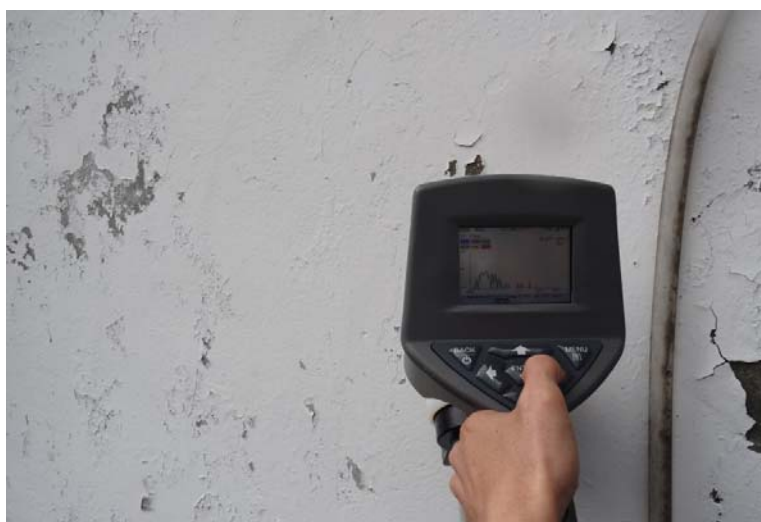
圖九：正對基地台時顯示 5568 cps，貼向牆面後數值降為 102 cps
