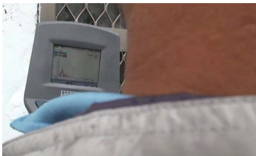
圖七：有人體擋在基地台與儀器中間的數值顯示 190 cps
