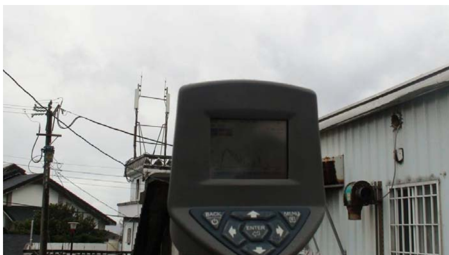
圖十一：在椰油及紅頭村的大哥大基地台進行測試，因其型式與朗島不同，均無發送會影響 BNC SAM-940 的電子磁場，所以儀器顯示正常
