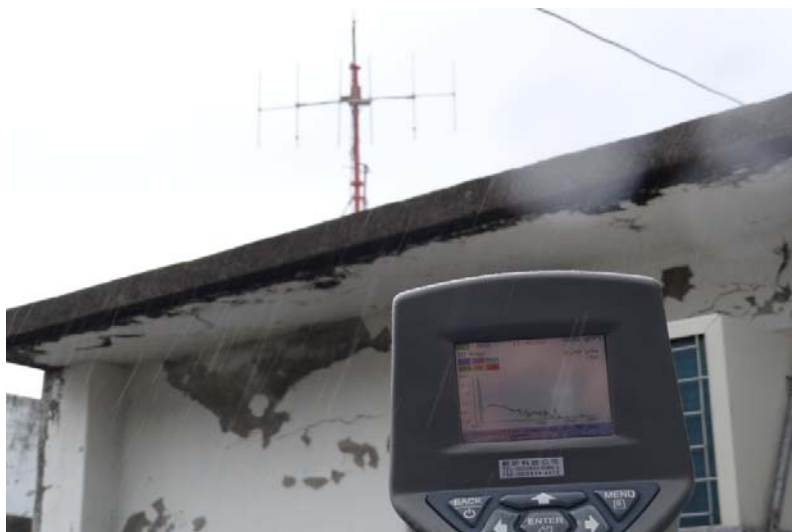
圖八：將 BNC SAM-940 偵測器正對基地台時，儀器數值馬上升高
