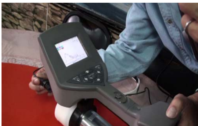
圖十：BNC SAM-940 在充電時，會因插入充電插座，造成內部電子磁場，而顯示錯誤數值。插入充電器線路前未出現突波(右圖)，插入充電器線路後，出現突波(左圖)
