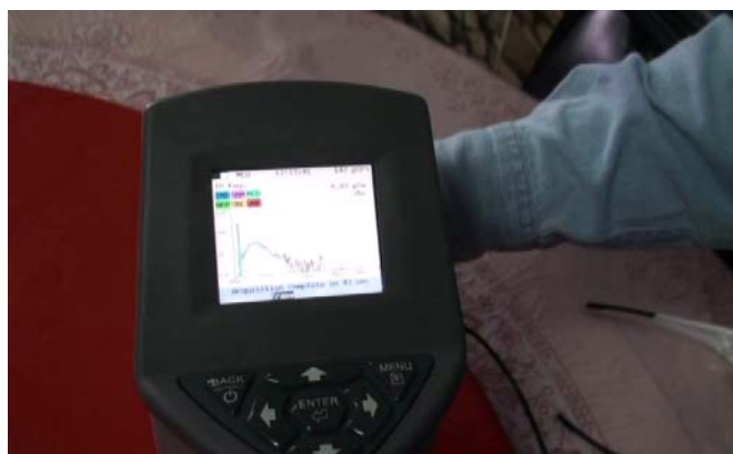
圖十：BNC SAM-940 在充電時，會因插入充電插座，造成內部電子磁場，而顯示錯誤數值。插入充電器線路前未出現突波(右圖)，插入充電器線路後，出現突波(左圖)
