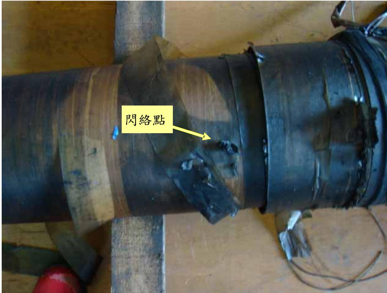
圖 15 閃絡點(對應導體及絕緣紙電容體閃絡處)
